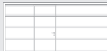
Symmetrische plaatsing bij DB 2.000 - 3.500 mm – alleen in het midden
