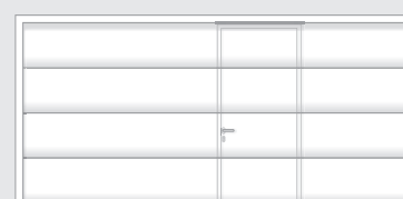
Asymmetrische plaatsing bij poortbreedte DB 3.501 - 4.250 mm – links of rechts ten opzichte van het midden
